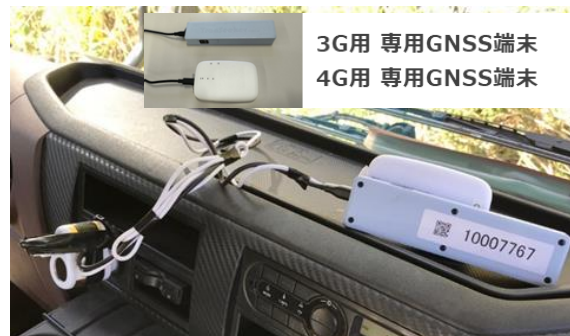
写真-1 運搬車両内のIoT機器 (GNSS) 搭載状況
