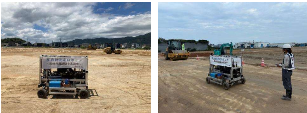
図 1 自動透過型 RI 計測ロボット
