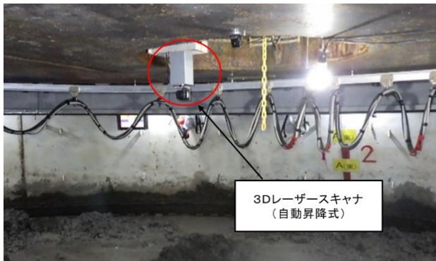
写真1 3Dレーザースキャナによる 点群データ取得状況
