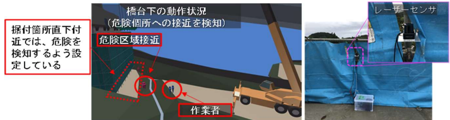
図 4 危険箇所接近時 3Dモデル (左) レーザーセンサ (右)
