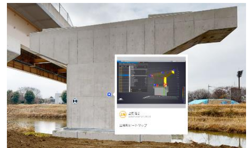
写真 8 橋梁下部工でのタグ機能
