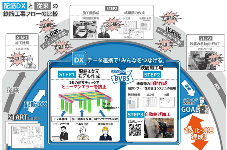
図 1 配筋 DX の 3 ステップ
