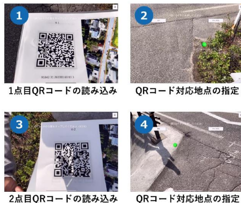
写真 4 QR コードによる測位誤差の補正
