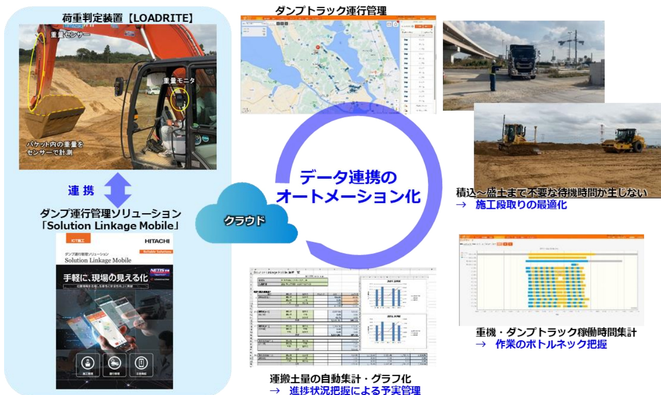
図1 荷重判定装置とダンブ運行管理ソリューションの連携イメージ図
