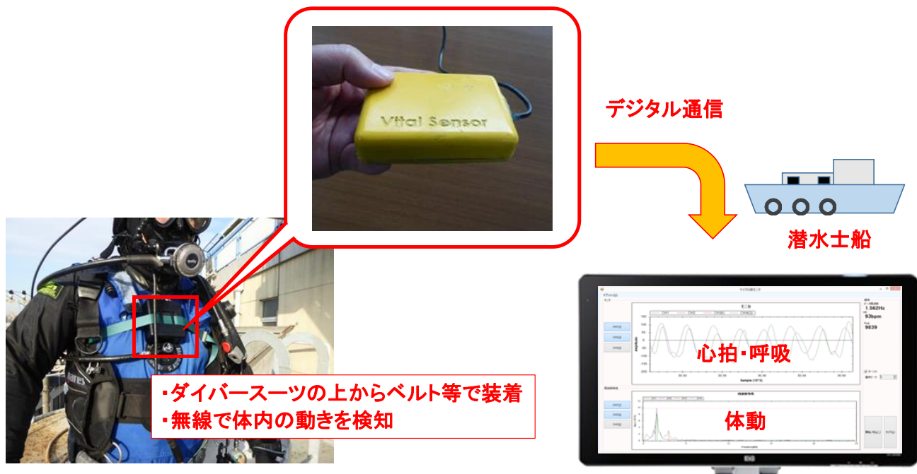
図 1 潜水土バイタル情報検知システムの概要
