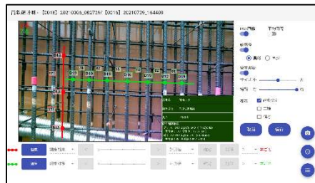
図-2 配筋間隔・鉄筋径の検測画面
