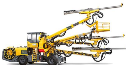
写真 1 コンピュータジャンボ (エピロック社 HP より)
