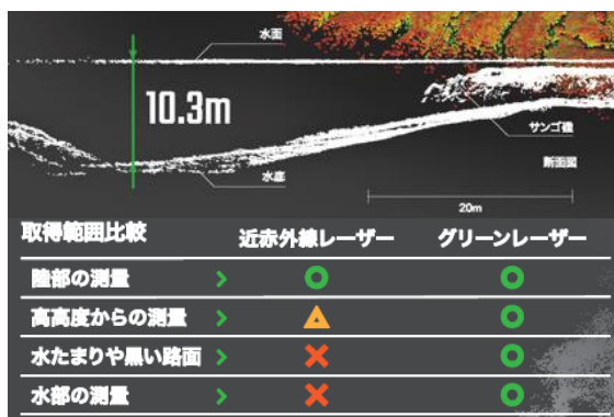
図1 グリーンレーザーによる水底点群データ例
