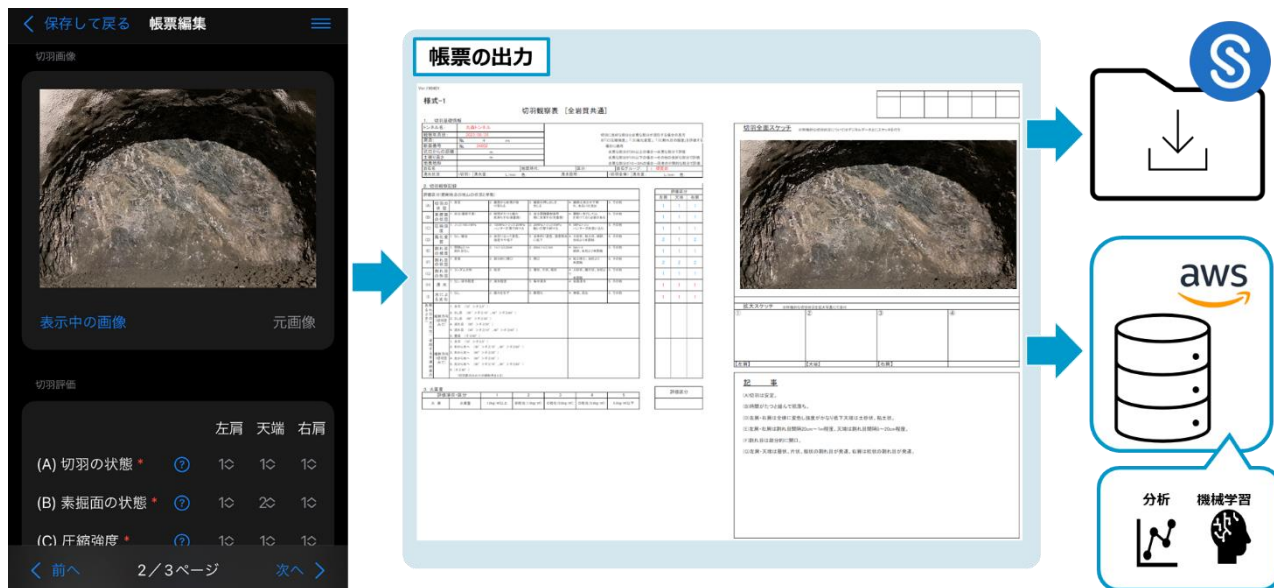
図-1 AI 切羽評価システム 概念図
