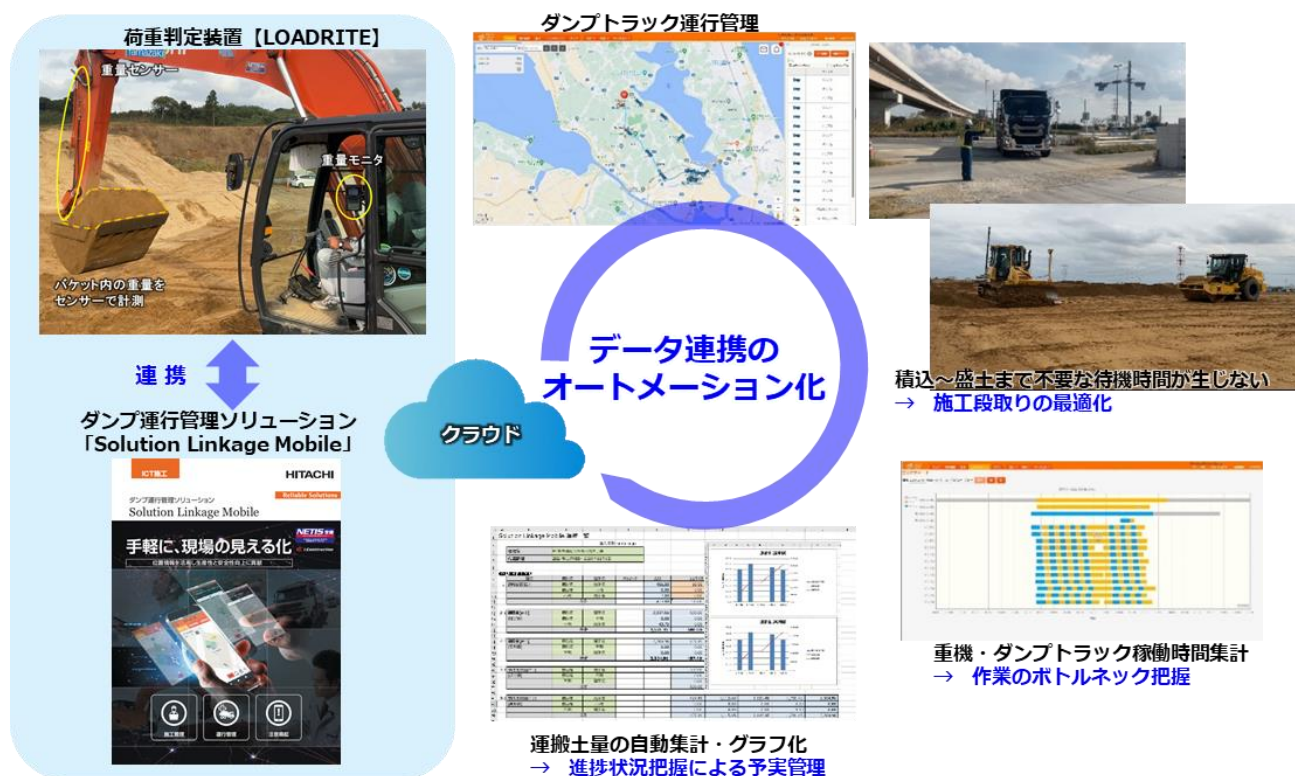
図1 荷重判定装置とダンプ運行管理ソリューションの連携イメージ図
