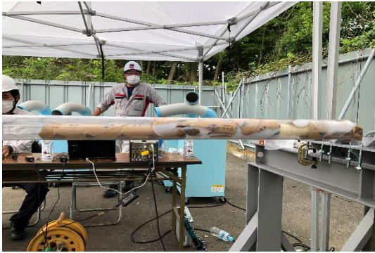
写真3：装薬孔内で圧縮された紙巻含水爆薬状況
