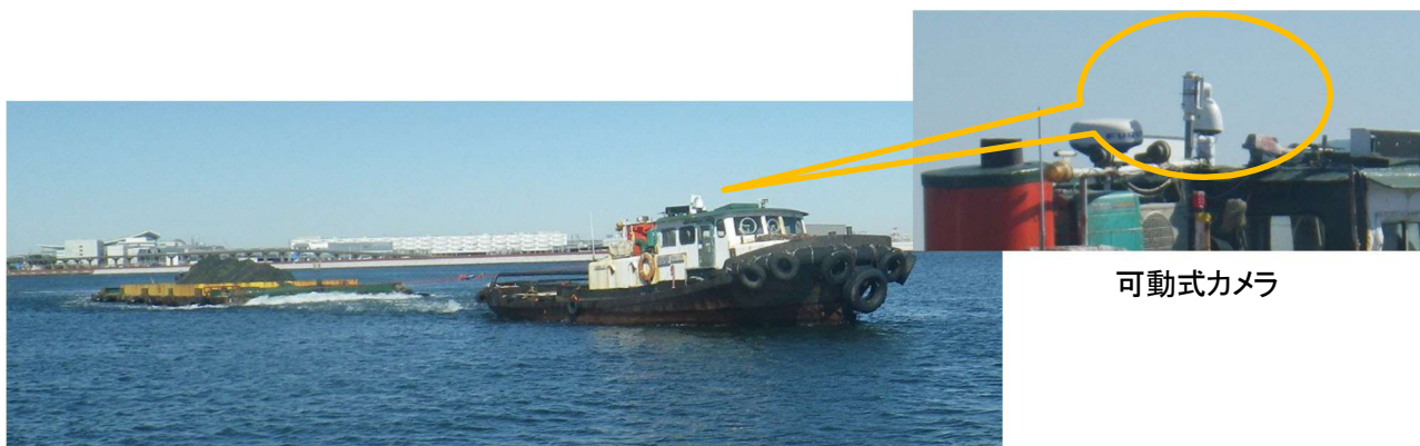
土運搬船曳航状況
