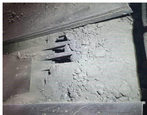
写真 2 閉塞したクラッシャー内部状況
