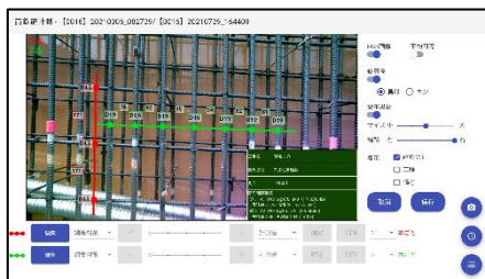
図-2 配筋間隔・鉄筋径の検測画面
