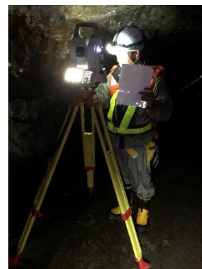
写真 2 トータルステーションによる追尾をしつつ ProScan で計測
