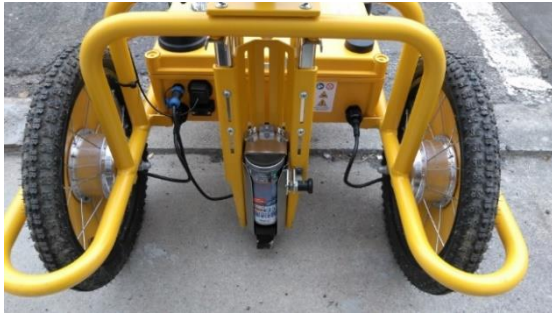
写真-3 スプレー缶設置状況
