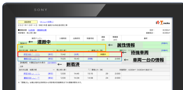
図-3 it-Trucks の運搬状況確認画面
