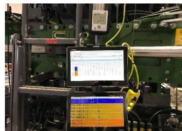
写真1. N-P Manager-Co 機材（2次元コード、データ確認端末）
