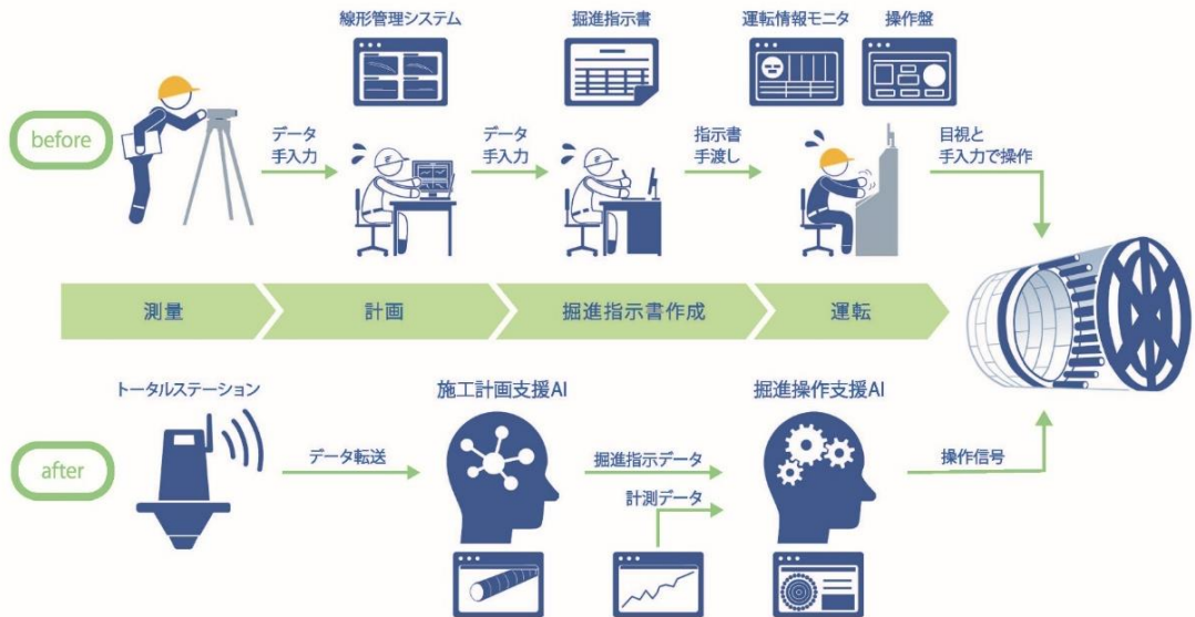
図-1 シミズ・シールド AI 概要図
