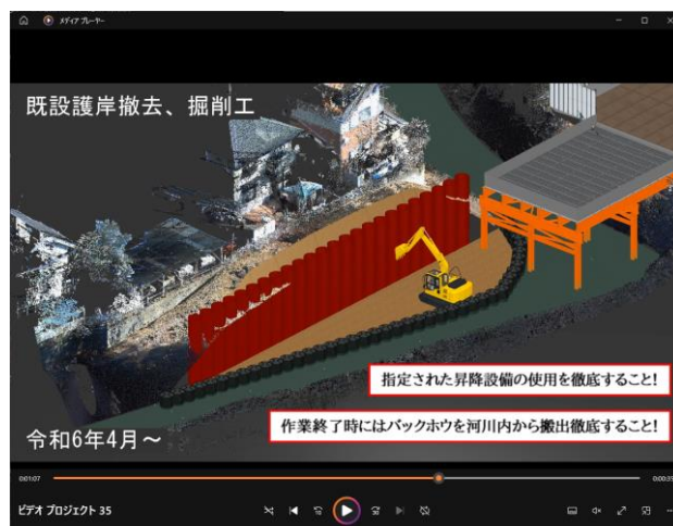
図2 動画再生画面 護岸工（鋼管杭）構築（左）と既設護岸撤去、掘削工（右）
