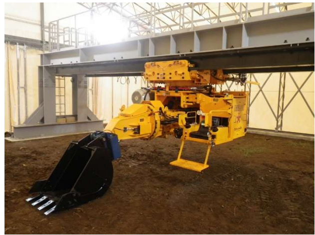
写真2 天井走行式掘削機 (0.3 m 3 )
