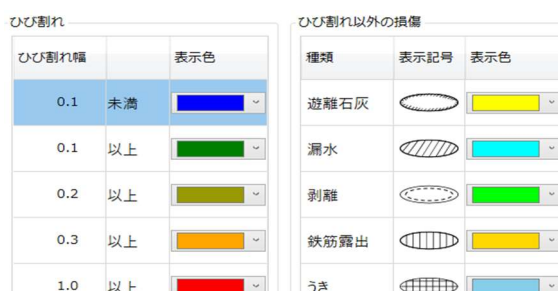
(写真-4) ひび割れ幅色別選択
