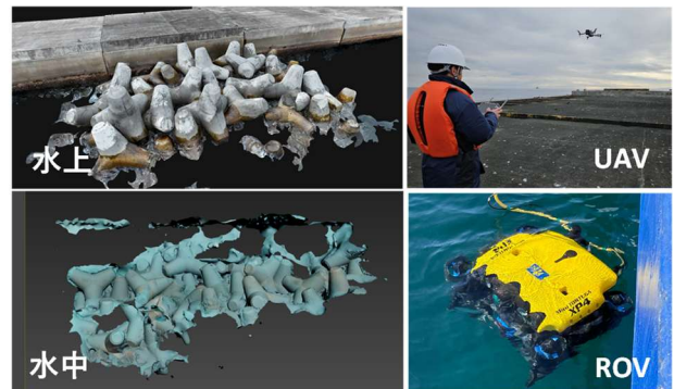
図5 据付形状の3次元モデル化
