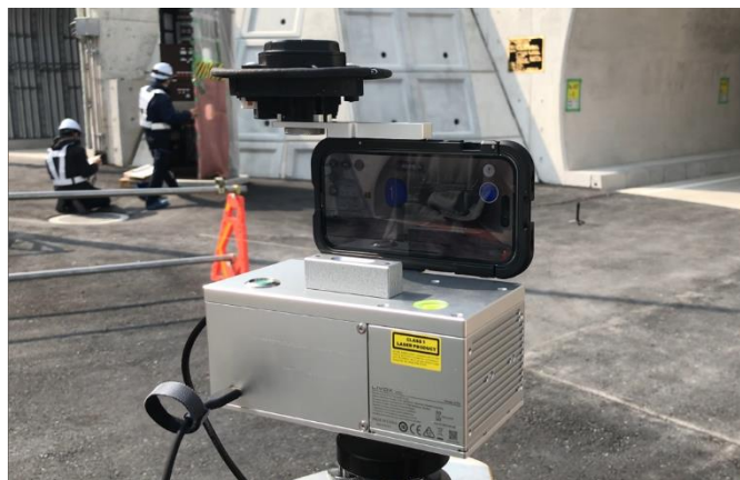
写真 2 外付け LiDAR センサー（GeoScan Advance）
