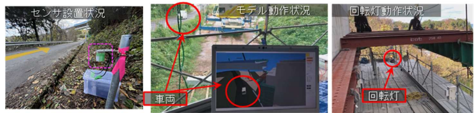
図 5 レーザーセンサ (左) 車両検知時 3Dモデル (中) 車両検知回転灯 (右)
