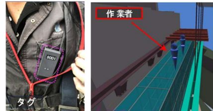
図 3 UWB タグ (左) 作業者測位 3Dモデル (右)
