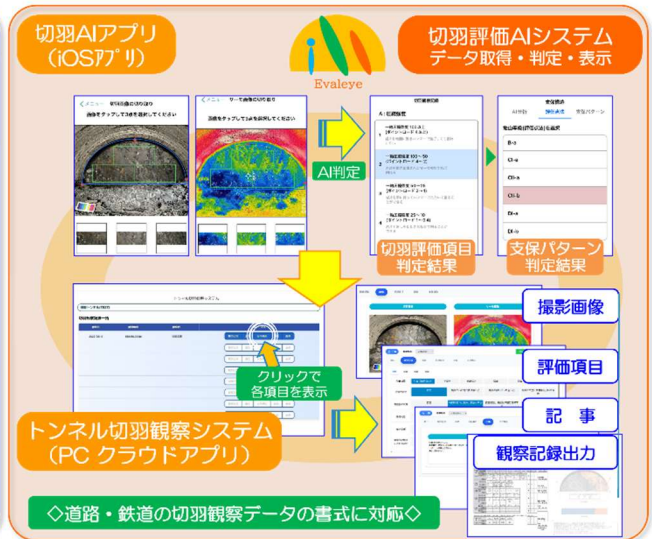
図-3 トンネル切羽評価 AI システム 「Evaleye」の解析イメージ
