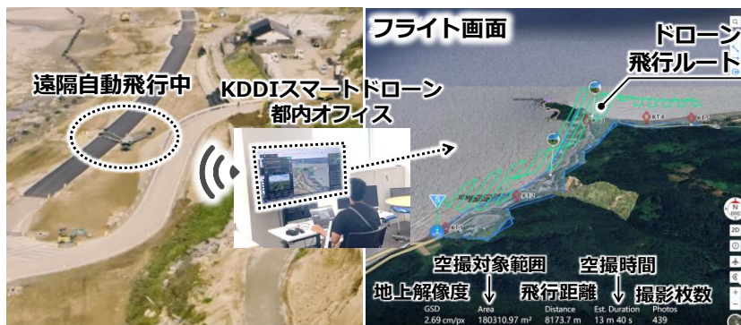
図-2 ドローン遠隔自動空撮状況
