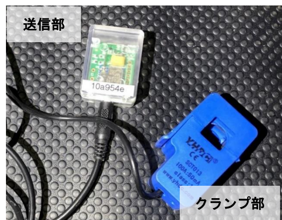
写真1 電力センサー
