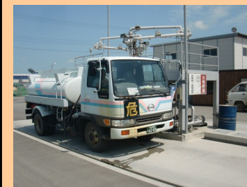
荷台のタンクに燃料油を入れて運搬します
