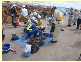
遮蔽放射線量率を測定するための「縮分法」によるサンプル採取
