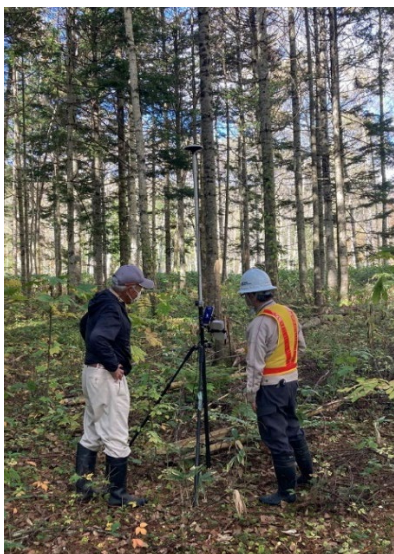
写真 樹林中での計測状況（ポール高：最大 4.5m）と計測時画面表示（例）
