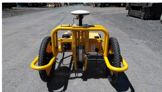
写真- 2 マーキングロボット（後ろ側）
