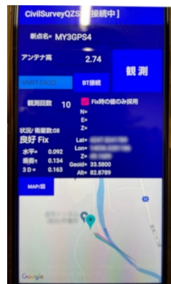
写真 樹林中での計測状況（ポール高：最大 4.5m）と計測時画面表示（例）
