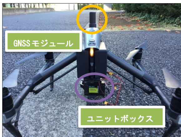
図 1-1 UAV 機体+PPK ユニット
