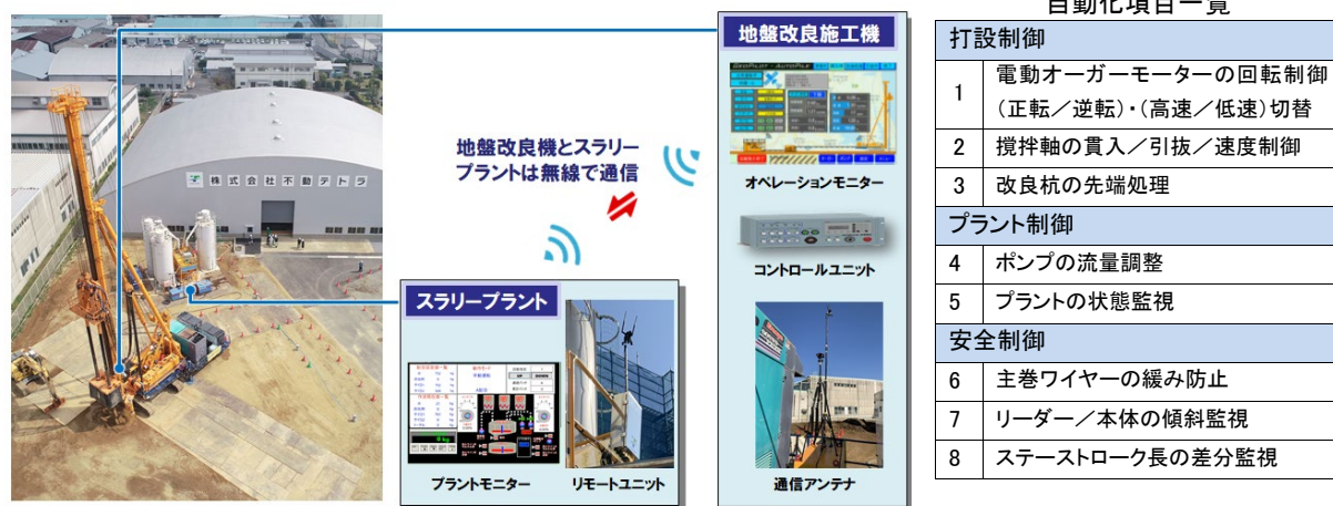
図-1 深層混合処理工法の自動化施工システム（GeoPilot-AutoPile）
