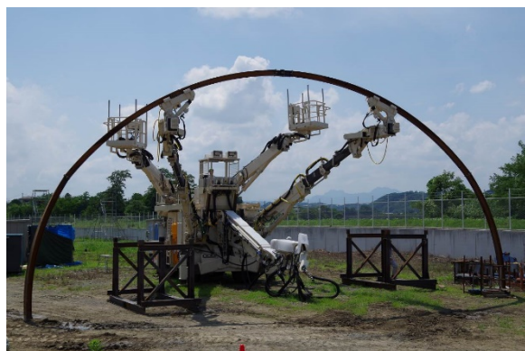
写真-1 鋼製支保工建込みロボットの全景
