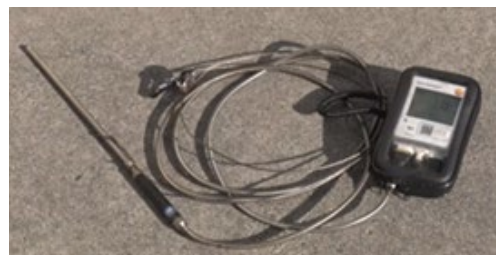
写真1 Nコレ・サーマル機材 (Wi-Fi 温度ロガー、特殊 K 熱電対)
