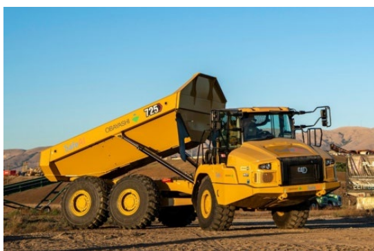
写真-1 自律走行システムを搭載した ADT
