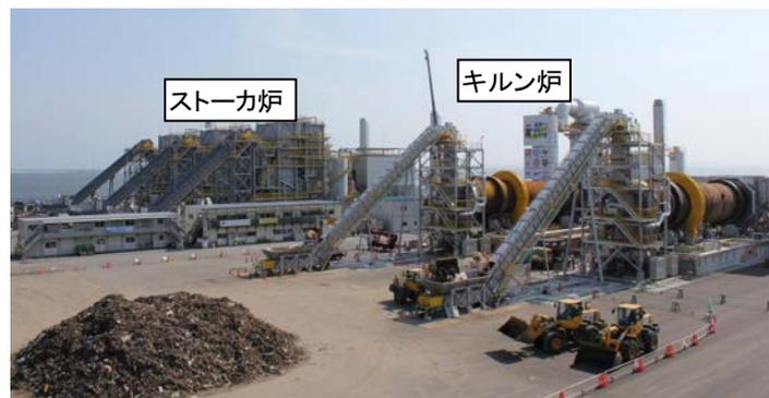
写真-13 稼働中の仮設焼却炉（宮城県：石巻ブロック）
