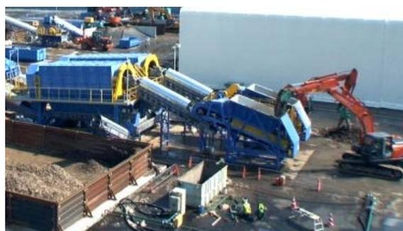
写真-10 回転選別機による選別状況(宮城県:南三陸処理区)
