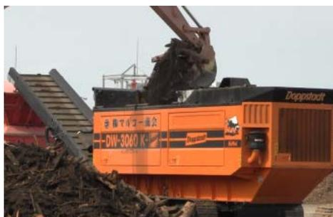
写真-8 木くず破碎状況(宮城県:山元処理区)
