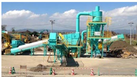
写真-11 風力選別状況(宮城県:岩沼処理区)
