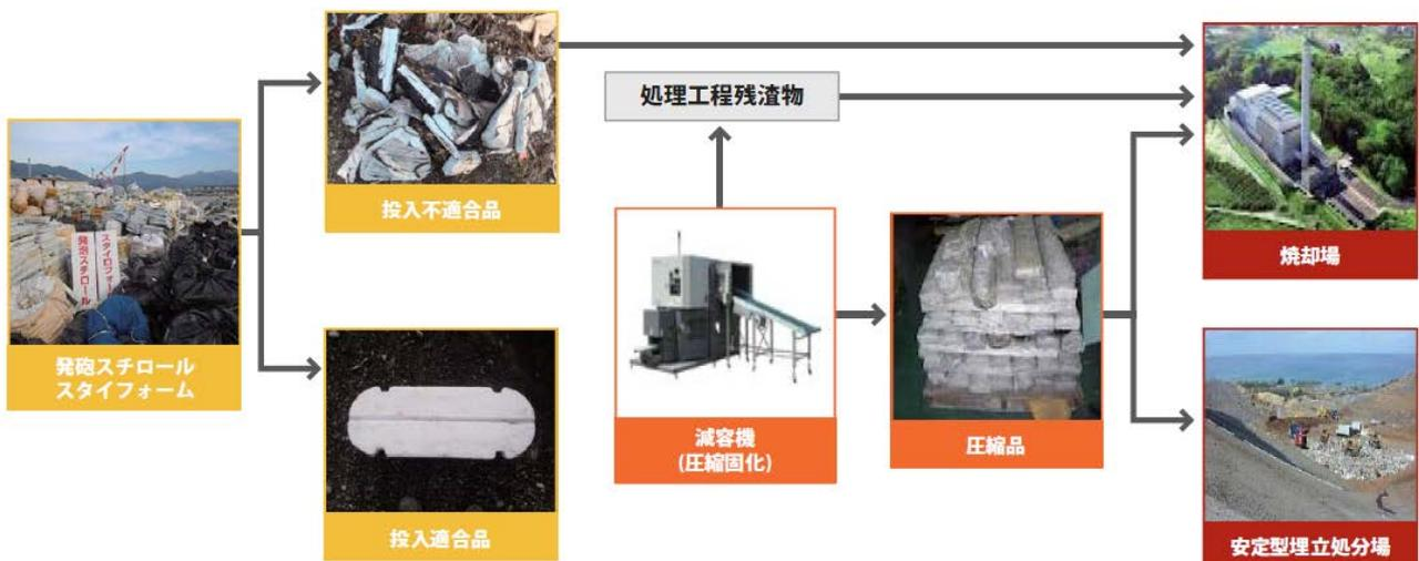
図-8 発泡スチロール等の処理フロー（岩手県：宮古地区）
