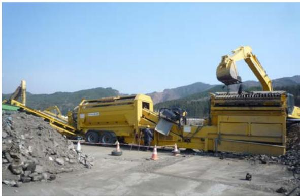
写真-3 回転選別機による選別状況
