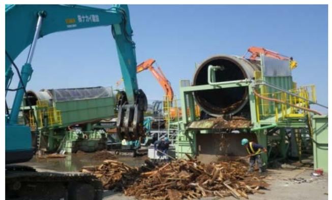
写真-12 木材洗浄機による洗浄
