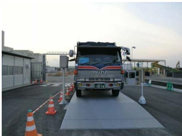
写真-26 トラックスケールによる計量
