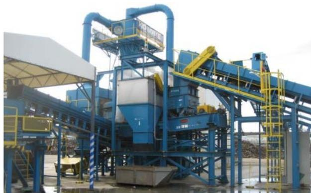
写真-6 磁力・振動・風力選別機による二次分別
