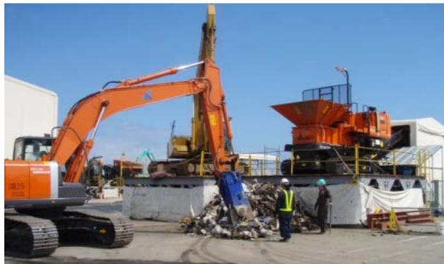
写真-18 可燃粗大物の切断
