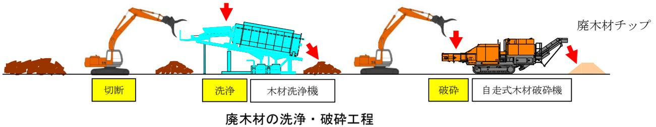
水洗浄により塩分を洗い流し、塩素分を 1,000mg/kg 以下を目標に低減
