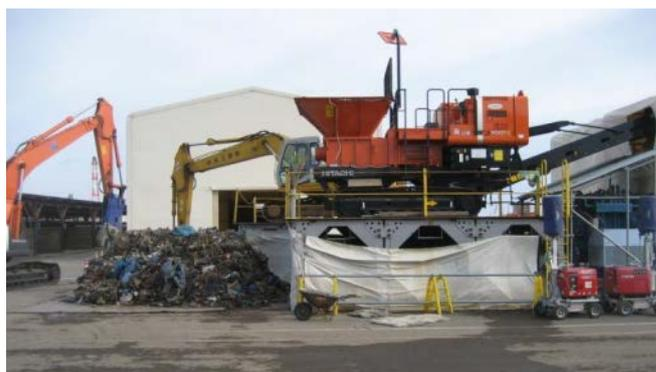
写真-19 破砕機による破砕
