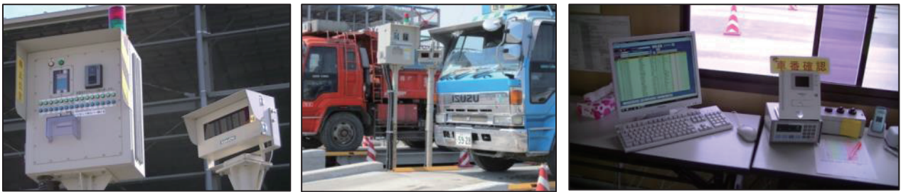
写真-1 搬入出計量システム
