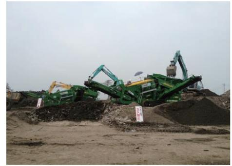
写真-13 津波堆積物分級処理
