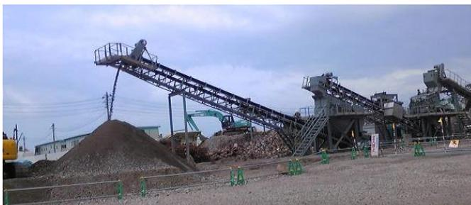
写真-9 固定式破碎機による破碎状況
