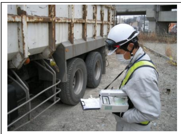
写真-11 搬出時の空間線量測定
