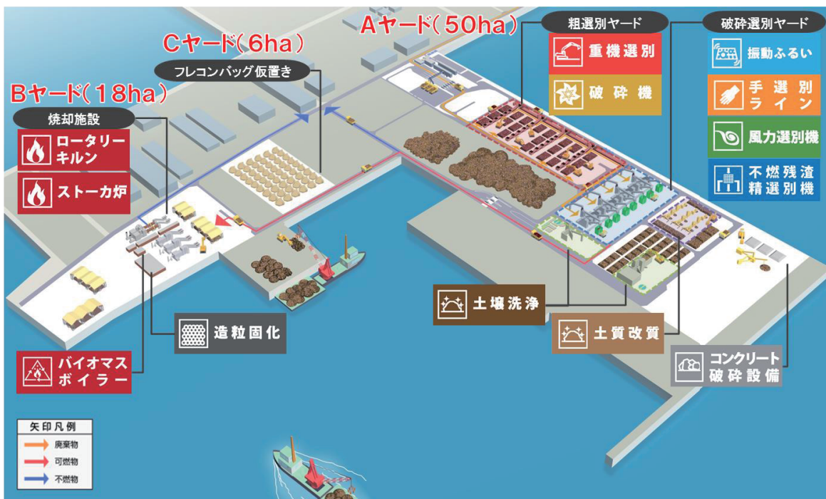
図-1 二次仮置き場の施設配置
