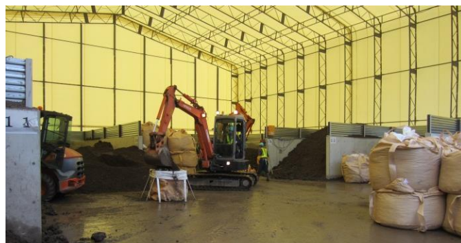
写真-13 焼却主灰の保管状況
