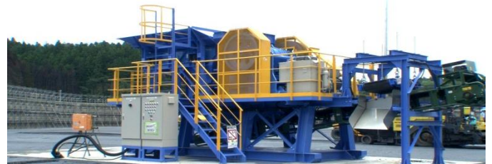
写真-9 コンクリートガラ破碎機
