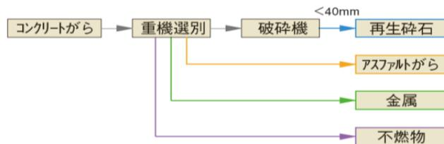
図-9 コンクリートガラ破碎フロー
