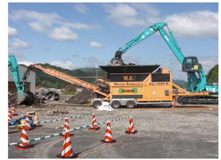
写真 5 大型破碎機
