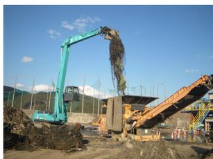
大型破碎機による破碎
