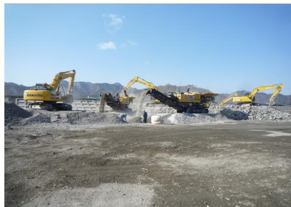
写真-9 コンクリートがら圧縮破碎
