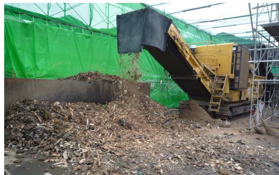
写真-8 可燃系混合物破碎状況
