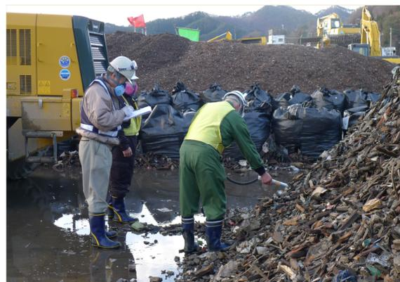
写真-12 可燃完成物放射線量計測
