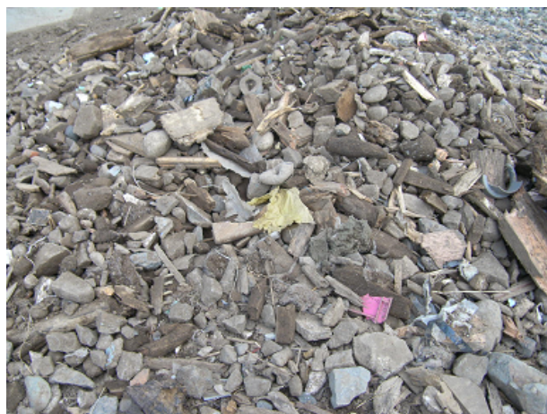
写真-8 分別除去された不燃物
