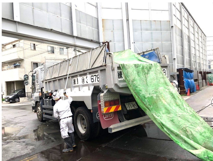
写真-3 荷台シート掛け状況
