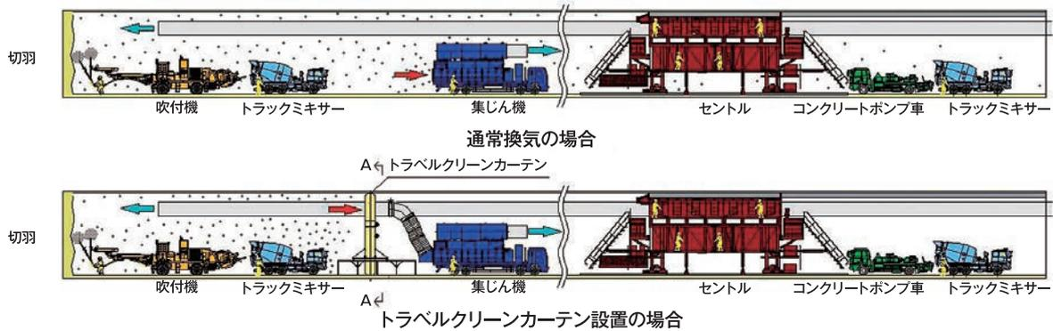
吸引捕集方式の「トラベルクリーンカーテン」は開閉可能な隔離壁と集じん機および送気ファンから構成されます。発破掘削時、コンクリート吹付時の切羽付近で大量に粉じんが発生する際には、隔離壁車両通行部を閉じて粉じんを切羽近傍に閉じ込めます。発生した粉じんを封じ込め、効率的に集じんが行うことが可能です。
