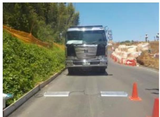
写真-3 積載重量測定
