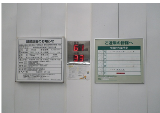
仮囲いに騒音・振動計の標示
