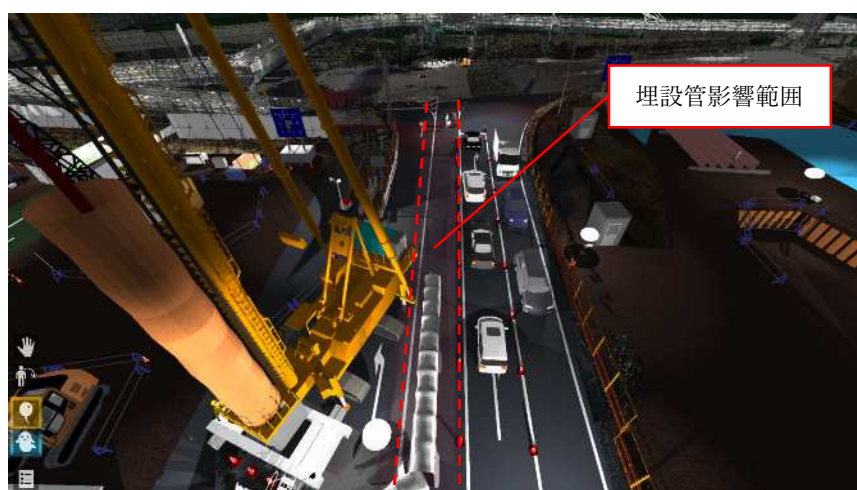
図-5 VR空間における埋設管への影響を考慮した重機配置検討
