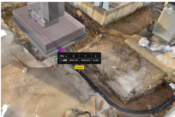
図-7 敷設した埋設管の点群データ
