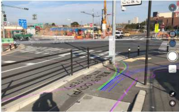
写真-6 ARによる埋設管の可視化
