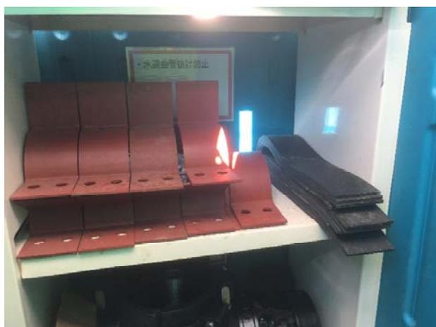
写真 10 水道曲管抜け防止材
