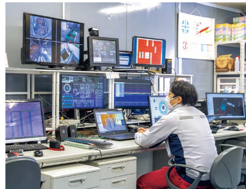
▲トラブルがあればすぐに対処するために、刻一刻と変化するシールドマシンの状況を監視しています
