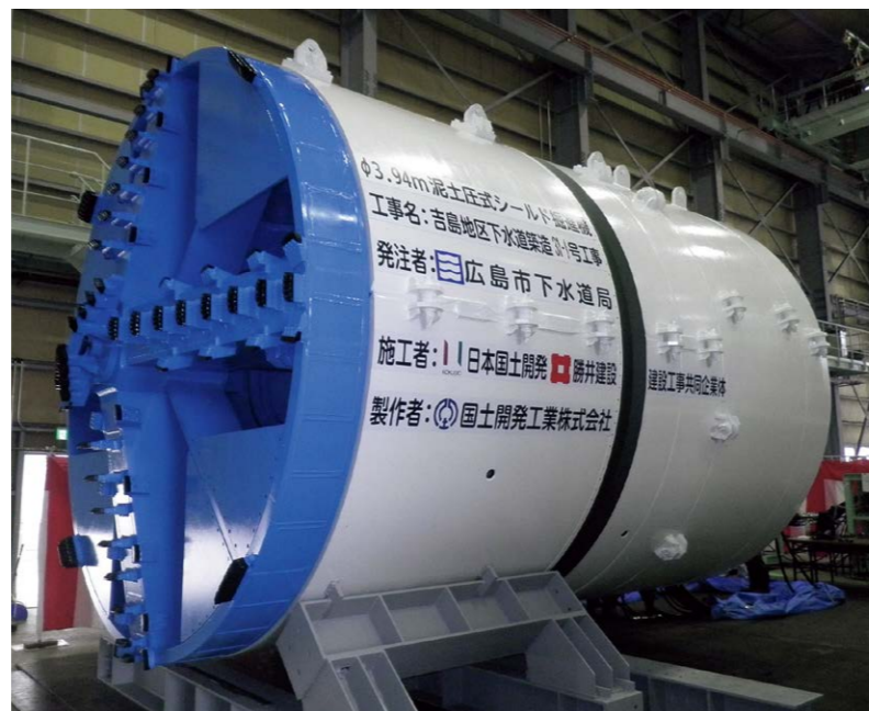
▲横穴の掘削を行っているシールドマシン
