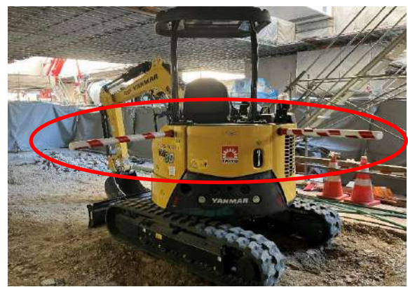
現場内の全ての重機に安全ポール取
