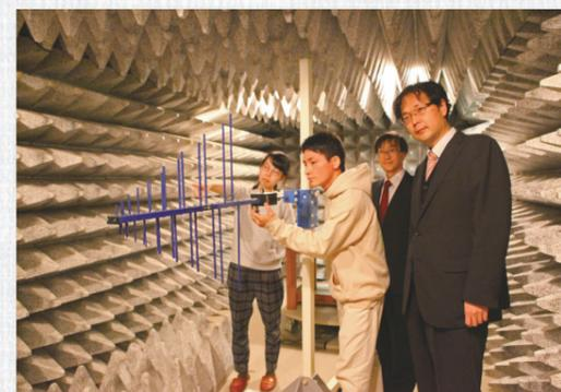
電波暗室における電波反射特性の測定
