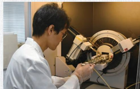
X線回折/リートベルト解析による建設材料の相組成評価
