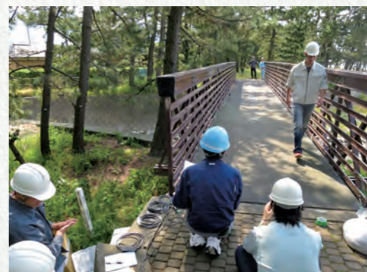
FRP 歩道橋の振動計測試験
