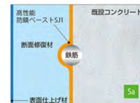
SSI 工法 施工断面図
