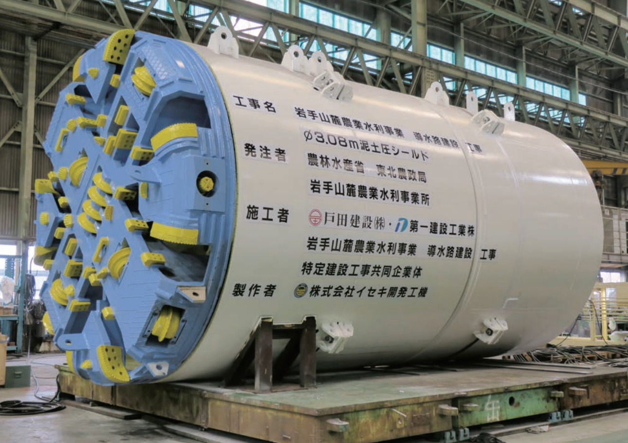
泥圧シールド工法マシン全景。前面のセミドーム型面盤のカッターで土を削り、スクリーコンベアにより土を運び出す。組み立てられたセグメントにシールドジャッキを押し付け、カッターを回転させて地山を削り、ジャッキを伸ばすことで前へ進む。
