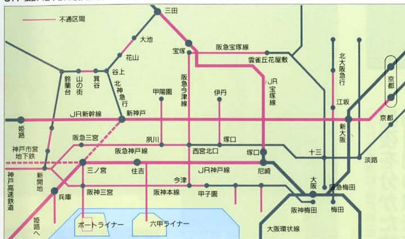
JR・私鉄・地下鉄の震災直後の不通区間 (1月18日)
