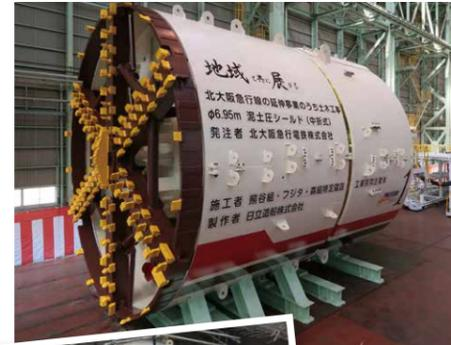
シールドマシン(上)と、組み立て中のシールドマシン(左)
