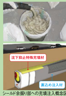
シールド余掘り部への充填注入概念図
