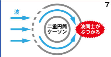
6. ケーソンは地上で製作し、海中に据え付ける。その大きさは圧巻! 7. 曲面で波を受け流しながら、波同士をぶつけて消波するシステム。8. コンクリートの色や規則正しく並んだ窓で景観にも配慮。
