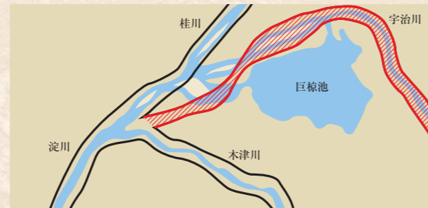
赤の斜線の領域が沖野が行った宇治川の付け替え工事。巨椋池は昭和16年に干拓され現在は陸地になっている。
