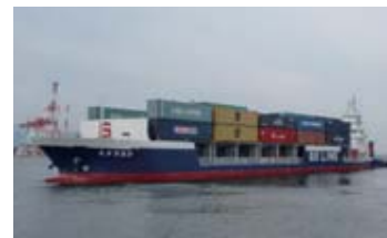
※9 フィーダー船(提供:西日本内航フィーダー合同会社) 阪神港などの主要港で大型船の貨物コンテナを積み替えて地方港(瀬戸内海など)に送り出す小型船。(地方港は水深が浅く大型船が入港できない)
