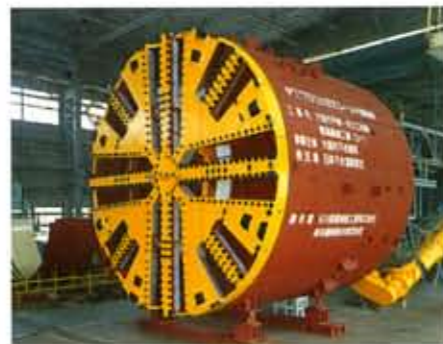
仕上がり内径6.5mのトンネルを掘るシールドマシン
