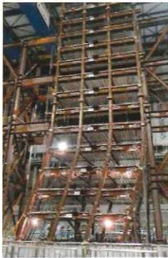
1/3縮尺の高層ビルの振動実験で、今回の対策で想定する揺れに対しては、倒壊までは通常、一定の余裕があると確認されています。ただし、より古い時代の超高層建築物では、さらに小さな加振レベルで建物の損傷が進む可能性があります。
