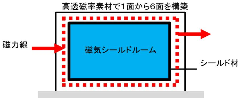
図2 磁気シールドのイメージ図
