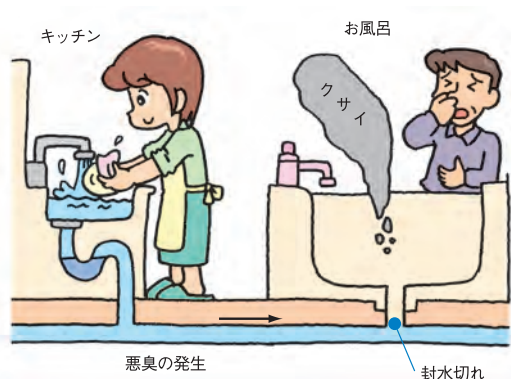
図1 封水切れによる悪臭の発生 2)
