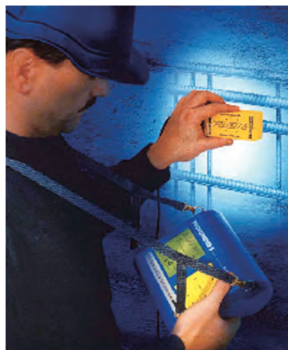
写真2 鉄筋探査機（プロフォメーター）
