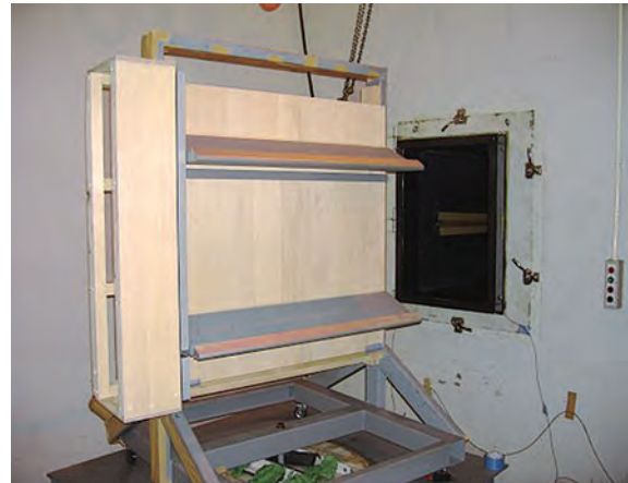
写真2 ルーバーの風切音試験状況
