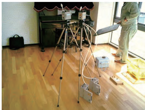
写真1 室内の化学物質濃度測定状況
