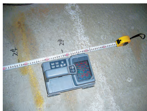
写真3 鉄筋探査機（RCレーダー）
