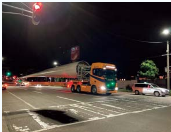
（写真5）港の仮置き場から工事現場まで運搬中。先導車を併走させながら、周囲にぶつからないように慎重に運んでいます。
