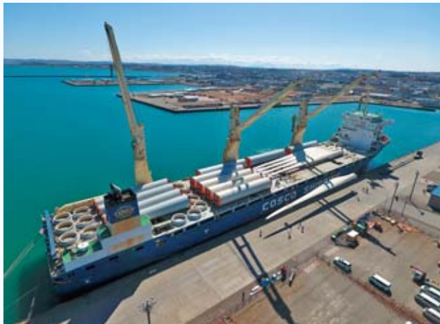
（写真3）港に到着した貨物船からブレードを荷卸しています。分割されたタワーと、1枚もののブレードが積みまれています。
