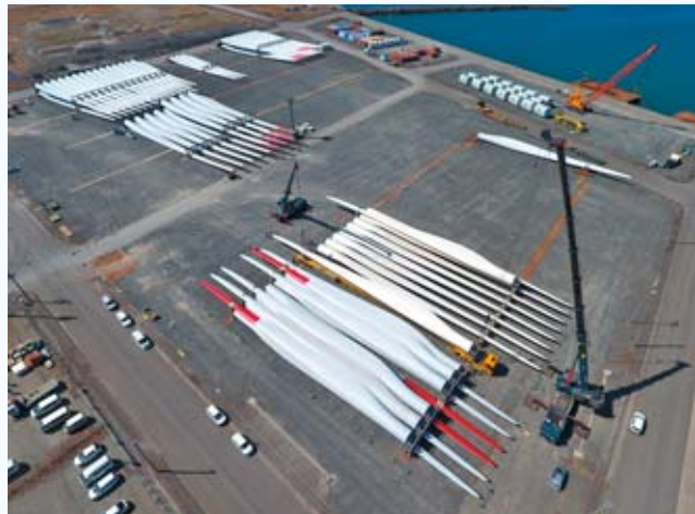
（写真4）荷卸した風車のパーツは港の敷地内に仮置きされます。人や車と比較して、貨物船もパーツも相当な大きさなのが見えます。
