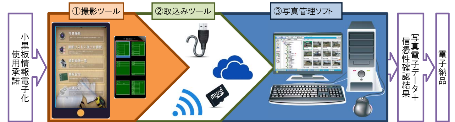
図-1.電子小黒板活用に必要なツールやソフトウェアの概念図
