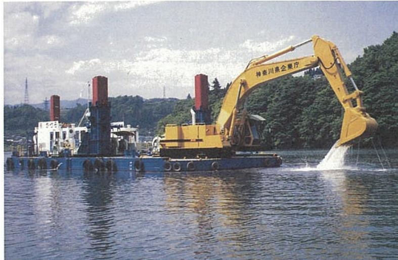
図-1.3.27 バックホウ浚渫船<sup>7)</sup>
