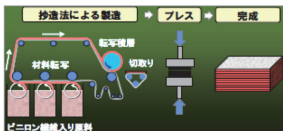
抄造法(和紙すきとりの原理)による製造方法
