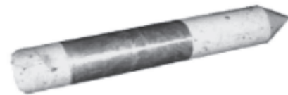
土中受信器の外観
