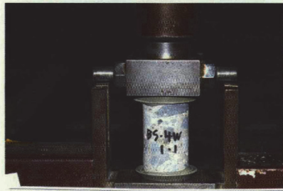
小径コア供試体 圧縮強度試験状況 2003年7月24日
