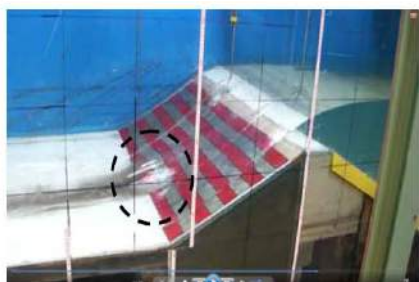
図 5.10 残留水位による裏法戻からの吸い出し
