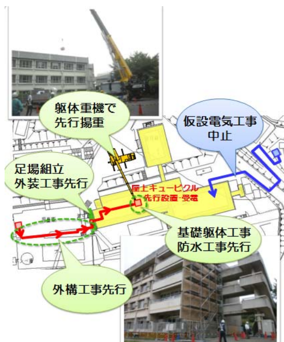
図5 先行受電状況
