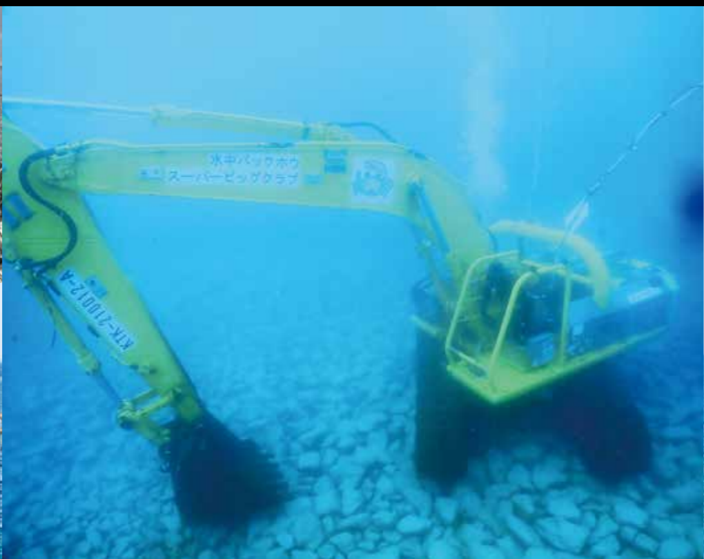
水中での稼働の様子。潜水士が運転席に乗り込み、バックホウを操作する。(提供:あおみ建設株)
