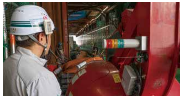
重機に取り付けられたセンサーとヘルメットのレーザー。一定距離まで近付くと黄色ランプとアラームで警告を発し、更に近付くと機械が停止するようになっているため、重機との接触事故防止に一役買っている。
