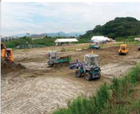
複数台の小型無人建機を用いた自動土砂運搬
