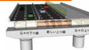
下り線ができれば、中央を上り線として活用し、元々の上り線のリニューアル工事を実施
