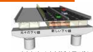
出来上がった中央部分を下り線として活用し、元々の下り線のリニューアル工事を実施
