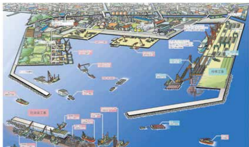
港湾の施設のうち、防波堤と護岸の工事を取り上げました。作業船の動きも含めた工事の流れの表現や、水中の様子の可視化などイラストの特徴を生かしたものとなっています。（関本）
